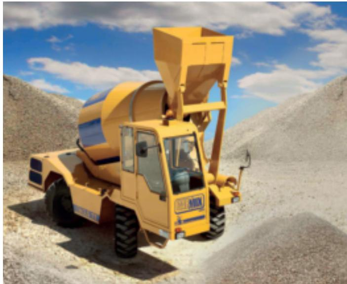
struzzo per inversione di marcia), dal sistema di pesatura a celle di carico e da una pala da 600 litri (controllabile con Joymix) con apertura a comando idraulico e scarico diretto nella betoniera di sabbia e ghiaia. Prodigioso vero? Certamente, e ora il piacere della scoperta spetta all'Italia del noleggio, che nei modelli Carmix può davvero trovare la risposta alla distribuzione smart di calcestruzzo in ogni contesto e necessità di cantiere.
